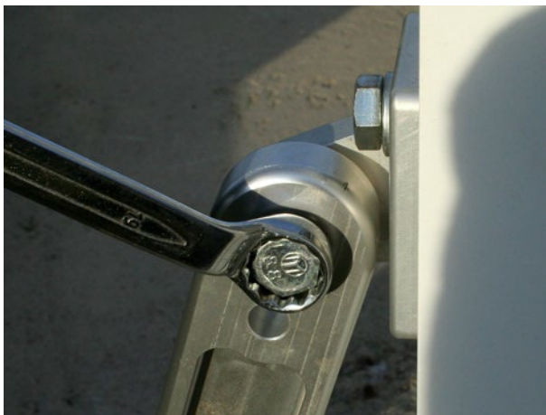
f. Därefter, dra åt den övre bulten på staget.
