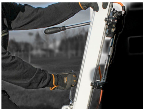
d. Dra åt bulten på det lägre fästet och den övre och Nedre bulten på staget.
