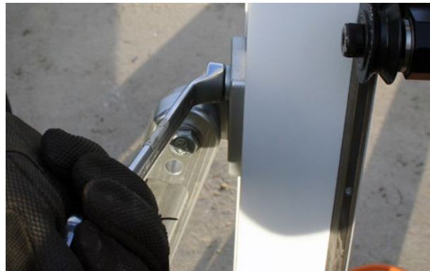
e. När rälsen är i rätt position, dra åt bulten ordentligt.
