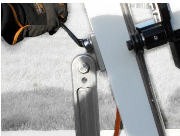
c. Lossa på bulten på det övre fästet och luta rälsen till önskad position framåt eller bakåt.
