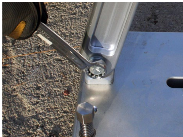
g. Dra åt den nedre bulten på staget.
