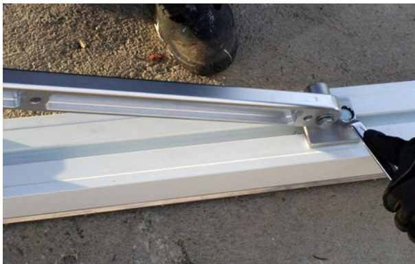
d. Dra åt den övre bulten på fästet lite lost. .
