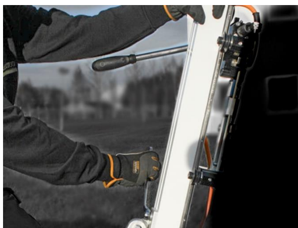
d. Spænd bolten på den nederste støtte og den øverste og nederste bolt på bagstøtten.
