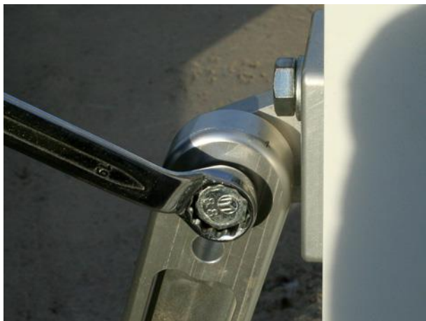
a. Løsn den øverste bolt på bagstøtten.
