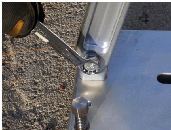
b. Løsn den nederste bolt på bagstøtten.
