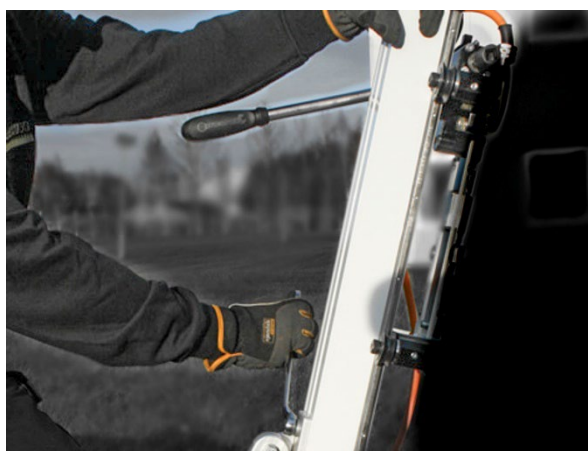
d. Kiristä alemman kannattimen pultti sekä takajäykisteen ylempi ja alempi pultti.
