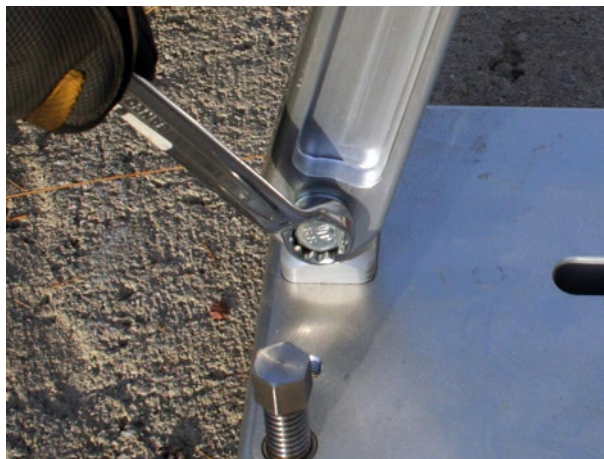
b. Desserrez le boulon inférieur du support arrière.
