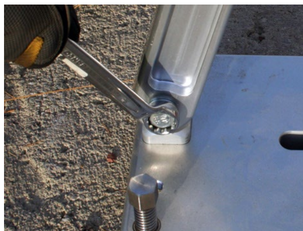
g. Serrez le boulon inférieur de l'étrier arrière.
