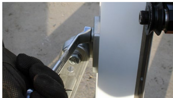
e. Lorsque le rail est dans la bonne position, serrez correctement le boulon.
