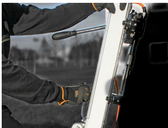
d. Serrez le boulon du support inférieur et les boulons supérieur et inférieur du support arrière.
