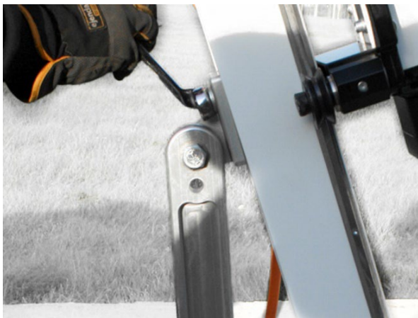
c. Den Bolzen auf der oberen Klemme lösen und Schiene nach Hinten oder Vorne lehnen.
