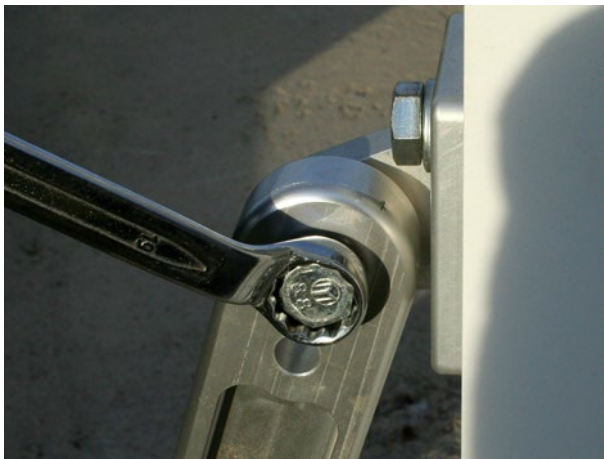
f. Als Nächstes wird die obere Schraube auf der Rückstütze zugezogen
