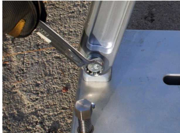
b. Den unteren Bolzen auf der Rückstütze lösen.
