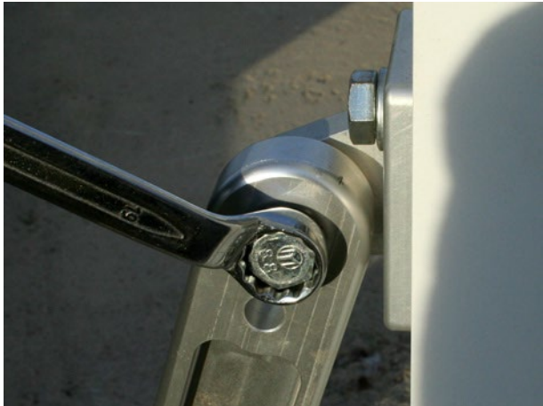
a. Den oberen Bolzen auf der Rückstütze lösen.
