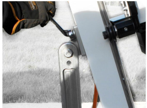
ג. הרפה את הידוק הבורג של התמך העליון והטה את המסילה למצב הרצוי לאחור או לפנים.
