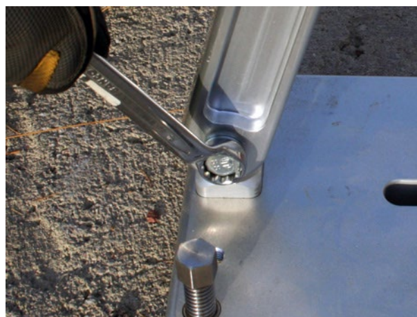
g. Serrare il bullone inferiore sul supporto posteriore.
