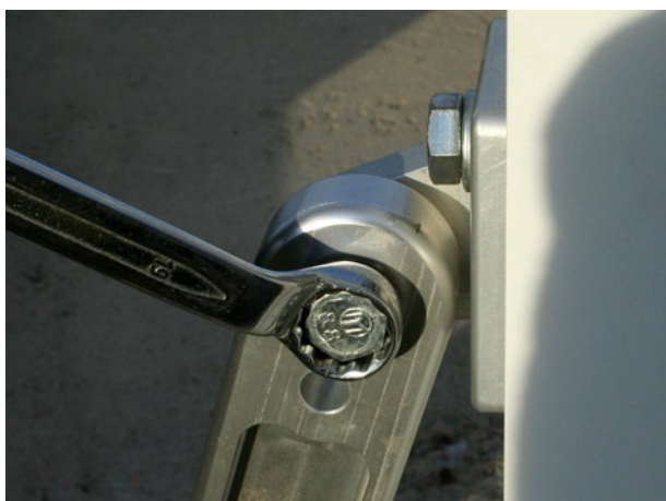
f. Serrare poi il bullone superiore sul supporto posteriore.
