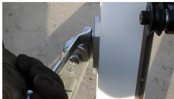
e. Quando la guida è in posizione corretta, serrare a fondo il bullone.
