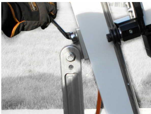
c. Draai de bout aan de bovenste beugel los en kantel de rail naar achteren of naar voren in de gewenste positie.
