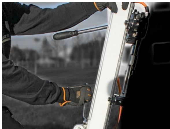
d. Draai de bout aan vast de onderste beugel, evenals de bovenste en onderste bout aan de schoor.
