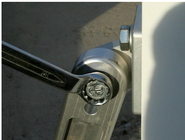
a. Draai de bovenste bout van de schoor los.
