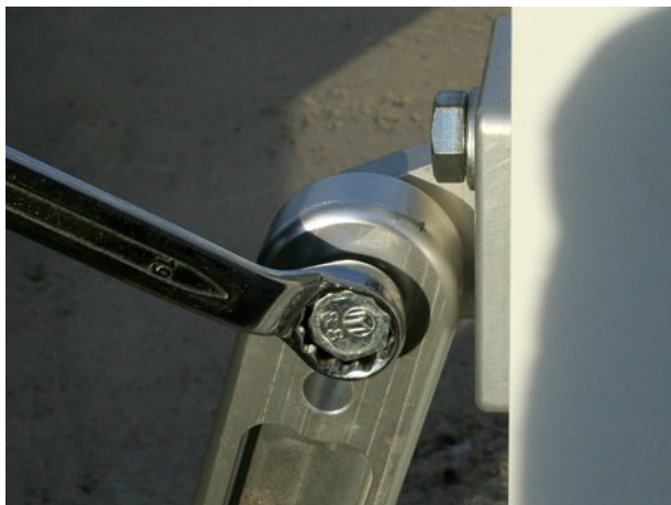
a. Løsne den øverste bolten på staget.
