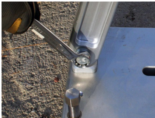
b. Løsne den nedre bolten på staget.
