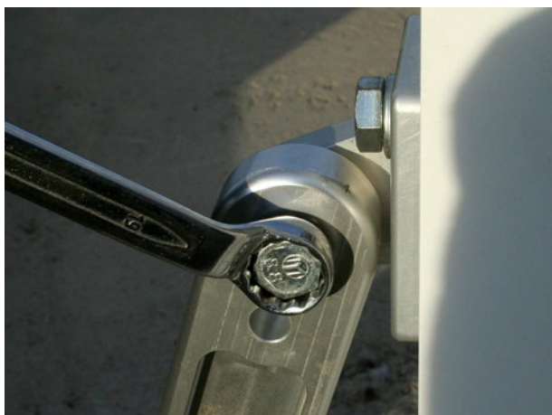
f. Trekk deretter til den øvre bolten på staget.
