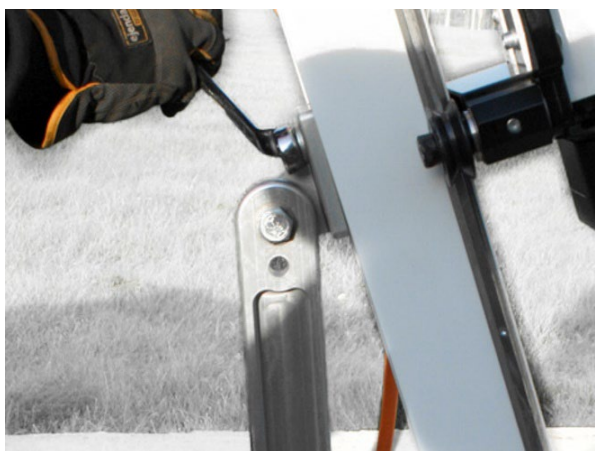
c. Løsne bolten på den øvre braketten og vipp skinnen til ønsket posisjon forover eller bakover.
