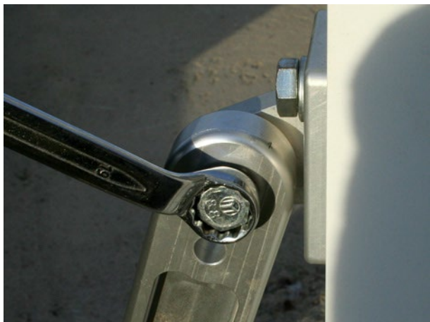
f. A continuación, apriete el perno superior en la abrazadera trasera.
