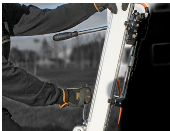
d. Apriete el perno de la abrazadera inferior y los pernos superior e inferior de la abrazadera
