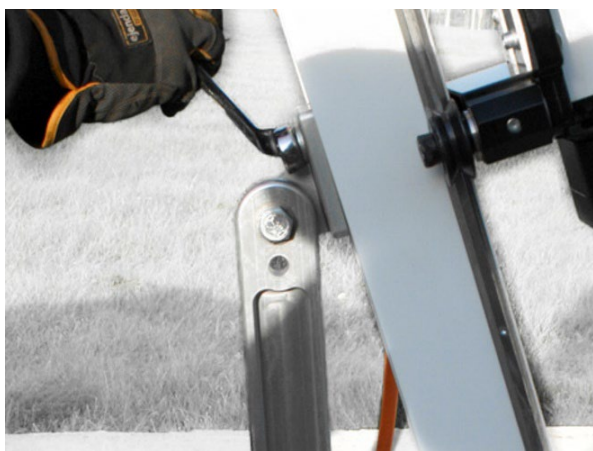
c. Afloje el perno de la abrazadera superior e incline la guía hacia la posición deseada hacia atrás o hacia delante.
